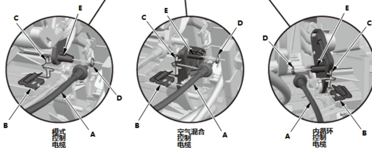
2. 将控制电缆 (A) 从夹 (B) 和凹槽 (C) 拆下。
